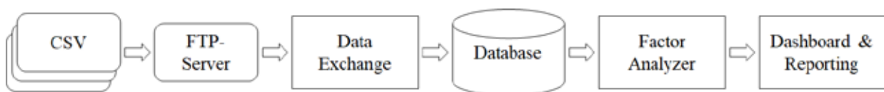
Рис. 1. Компоненти програмного забезпечення для аналізу ефективності систем управління запасами
